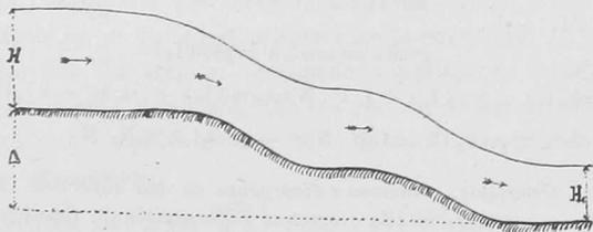
Detti  $c$  e  $c_1$  i valori delle velocità nelle predette sezioni e  $H$  l'altezza del pelo libero sul fondo, nella sezione a monte, il dislivello del fondo tra
